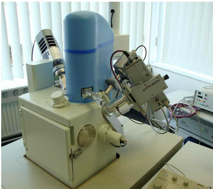
Рис.2 Фотография рентгеновского источника с микрофокусировкой, установленного в РЭМ Jeol 6610 с двумя ЭДД (производства компаний Bruker и Oxford Instruments)
