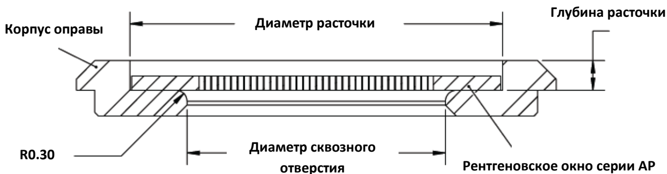
Рис.2 Параметры оправы для рентгеновских окон серии AP.
