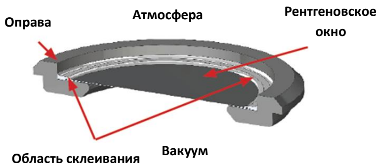
Рис.1 Крепление рентгеновских окон серии AP в оправу методом склеивания
