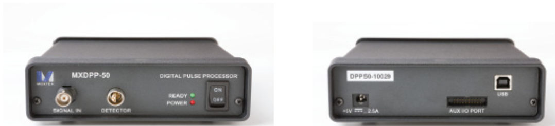
Рис.1 Передняя (слева) и задняя (справа) панели анализатора спектра MXDPP-50.
